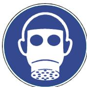
En caso de formación de polvo: protección respiratoria con filtro de partículas P2 o media máscara FFP1 - FFP3 según EN 149. Aplicación de concentración max. para sustancias con un valor límite:
