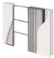
Parede de Gesso Cartonado Pared en cartón-yeso
