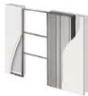
Parede de Gesso Cartonado Pared en cartón-yeso
