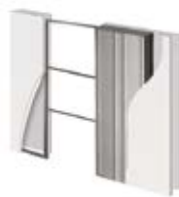
Pared de Gesso Cartonado Pared en cartón-yeso
